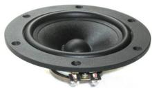
Среднечастотная головка МР1315.1.8 отличается гладкой АЧХ в широком диапазоне частот и низким уровнем искажений в среднечастотной области.
